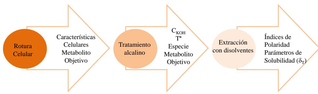
**Figura 5.** Resumen esquemático de la extracción de compuestos de alto valor añadido y principales variables de extracción.
