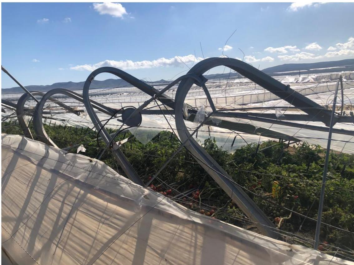
**Figura 11. Colapso de Invernadero tipo Almería por carga de granizo. Almería, enero 2020.**
