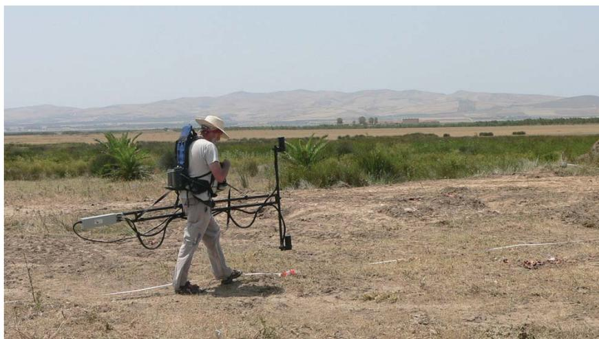
**Figura 7a.** Uso del magnetómetro en la Zona I.
