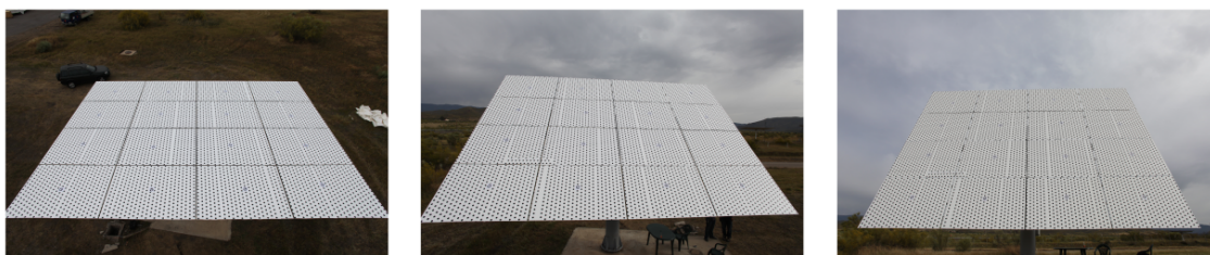
Figura 4.16: Prototipo de heliostato situado en el sistema CESA-I en las tres posiciones de medida definidas para fotogrametría: (a) 0^\circ , (b) 45^\circ y (c) 85^\circ . Fuente: elaboración propia.
