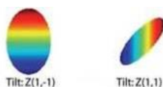
Figura 33. Representación gráfica de la aberración Tilt. Fuente: Soldevilla-Foj E. Estudio de la relación entre Aberraciones Oculares y Acomodación. [Trabajo Fin de Grado] Universidad de Zaragoza; 2014.
