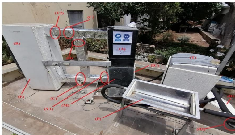
Figura 24. Equipo experimental de deshidratador solar construido.
