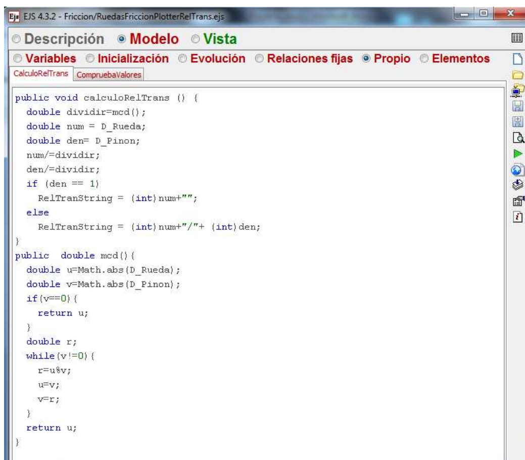
Figura 4-6. Método propio para calcular la relación de transmisión
