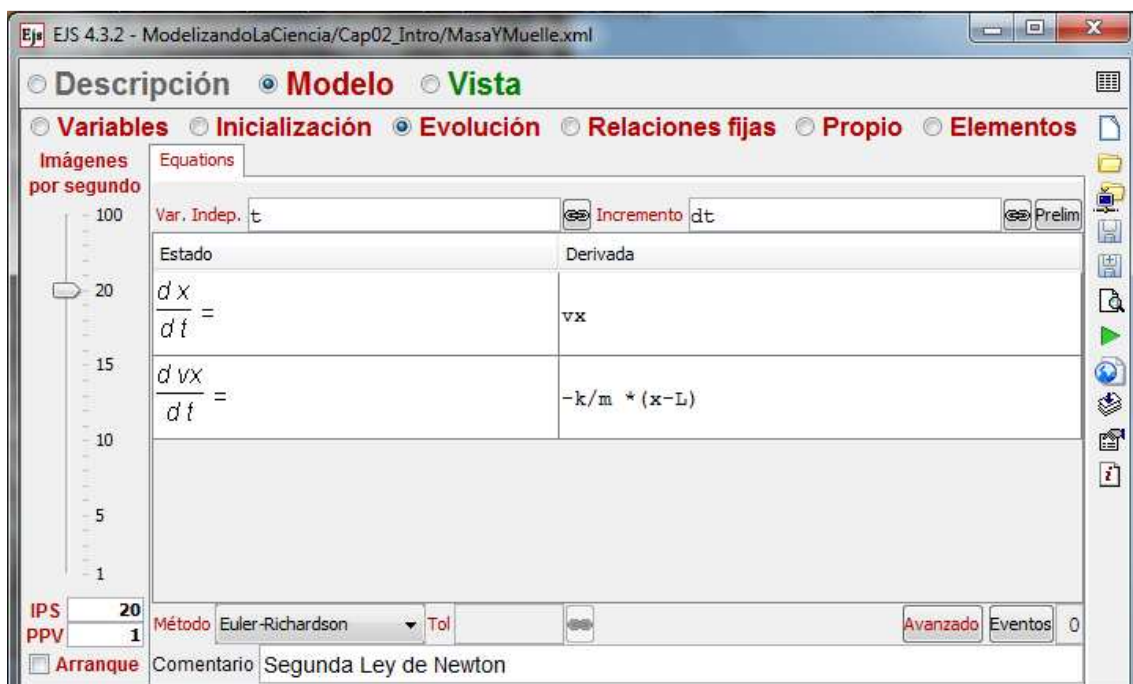
Figura 2-5. Aspecto del diseño del Modelo en el entorno EJS
