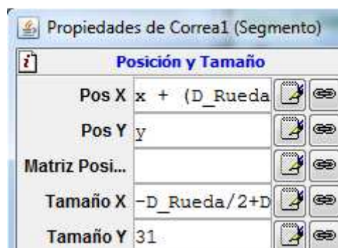
Figura 4-17. Tamaño de la correa en función del tamaño de la rueda
