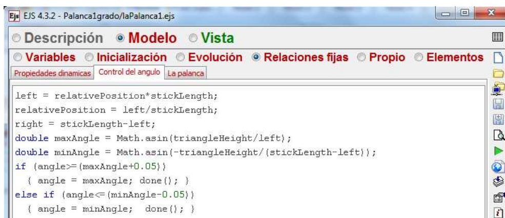
Figura 4-46. Relaciones fijas para controlar el ángulo
