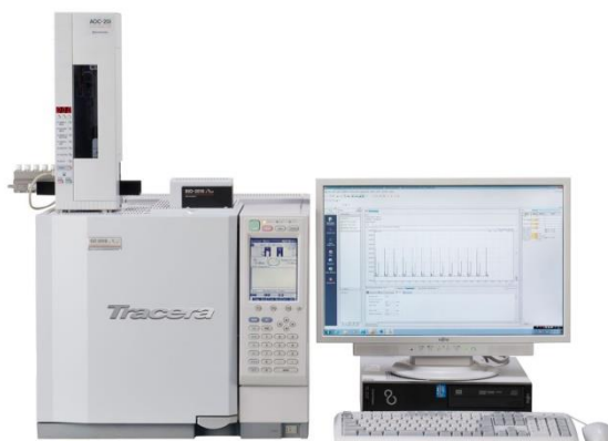
Figura 8. Cromatógrafo de gases
