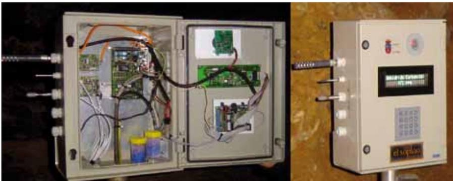
Figura 8. Vista interior y exterior de una estación remota CO<sub>2</sub>, HR, T y presencia.
