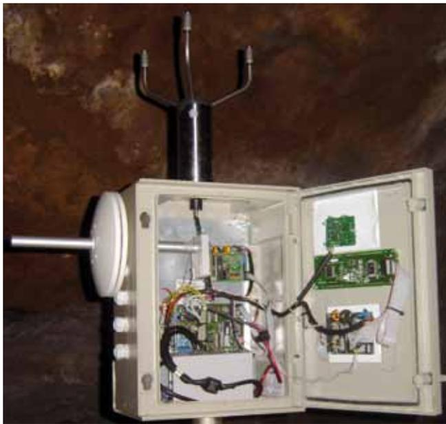
**Figura 9.** Vista interior de la estación remota del Viento.
