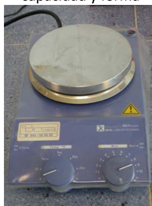
Figura 31. Agitador magnético regulable.
