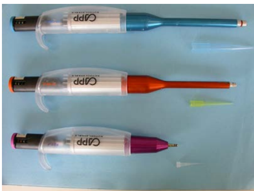
Figura 28. Micropipetas CAPP de 0,2-2 µl, 10-100 µl, y 100-1000 µl (µl =microlitros)
