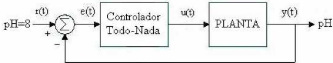
Fig. 3. Esquema de funcionamiento de un control Todo-Nada.
