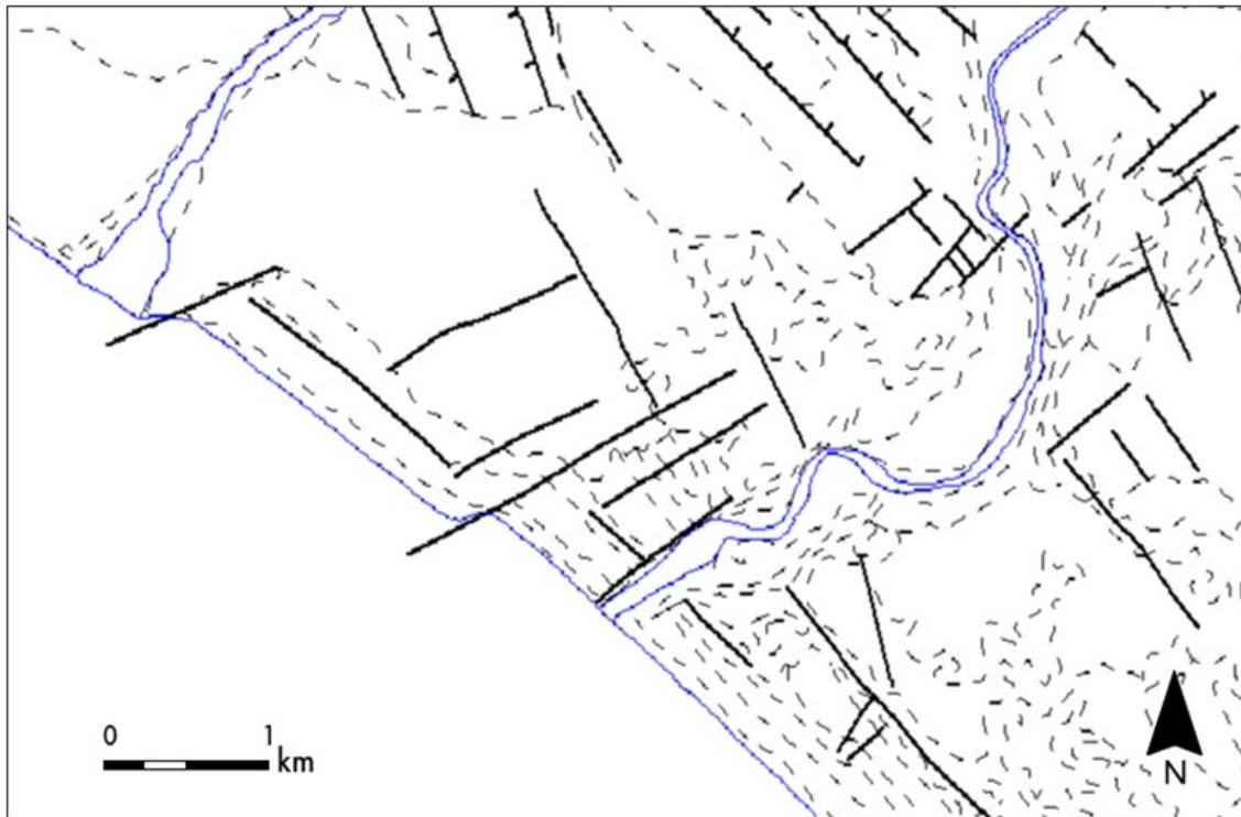
Figura 10. Mapa de detalle tectónico. En líneas punteadas las delimitaciones de materiales según su permeabilidad. Fuente IGME
