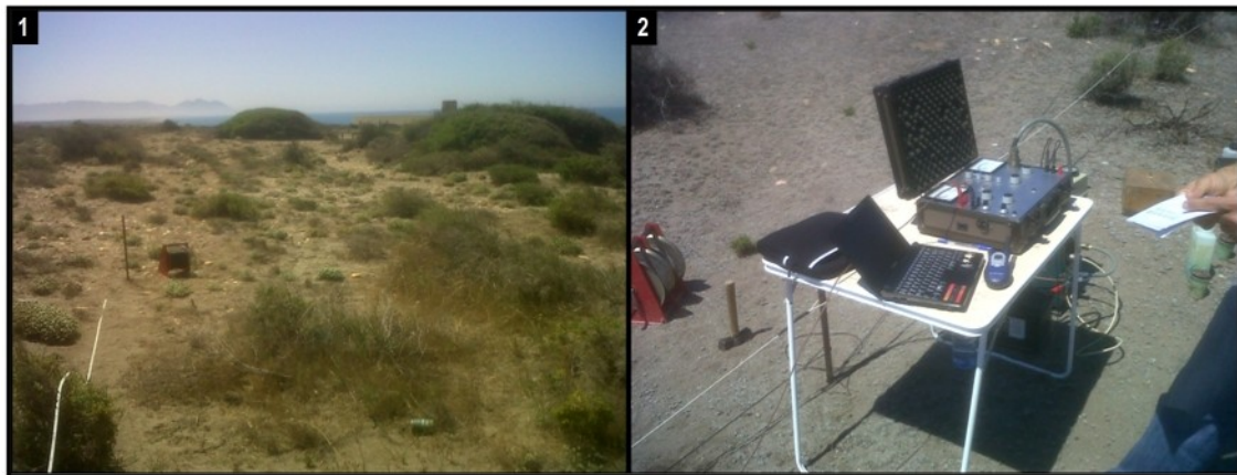
Figura 14. 1) Electrodo clase A o B y bobina de cable de 500 metros en campo. 2) Fotografía del dispositivo GEOTRON utilizado en campo (Schlumberger simétrico).
