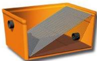
Figura MD.7: Funcionamiento general de los filtros para el desbaste.
