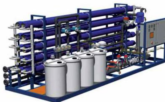
Figura MD.11: Unidad de ósmosis inversa.
