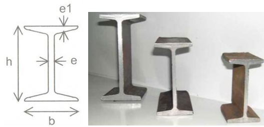
Figura A3.4: Perfil IPN común en forma de T doble [5].
