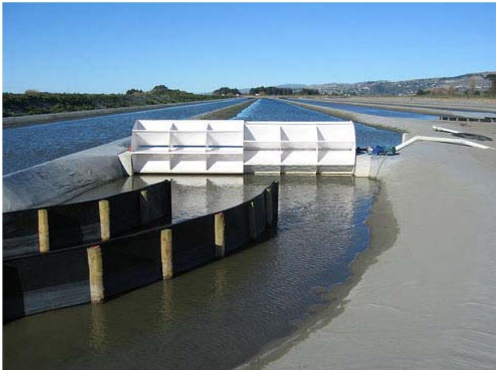
**Figura 3.**Fotografía un agitador rueda de paletas
