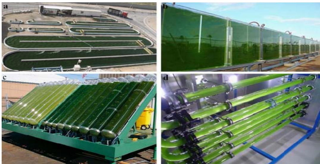
**Figura 6.** Configuraciones de fotobiorreactores (a raceway, b placas planas, c cilíndricos, d tubulares horizontales)
