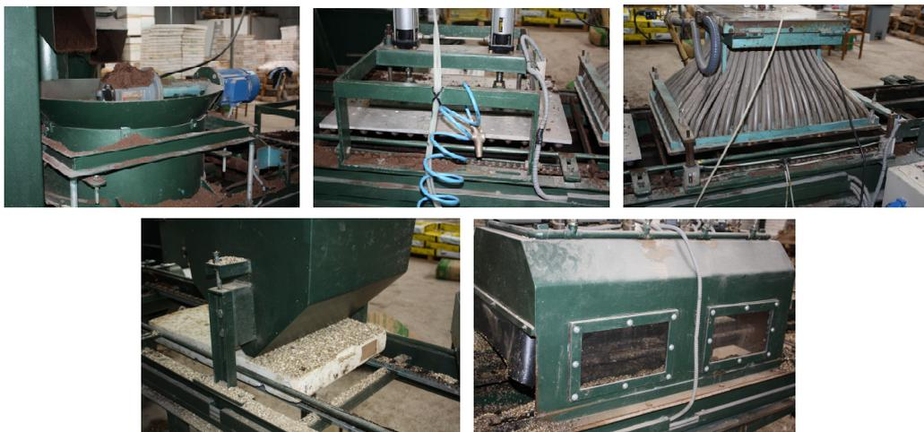
Figura 43. Detalle del módulo de llenado y prensado, módulo de punzonado, cabezal de siembra, módulo de tapado y túnel de riego, respectivamente.
