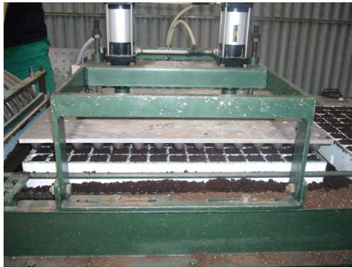
*Figura 14. Detalle de un módulo de punzonado*
