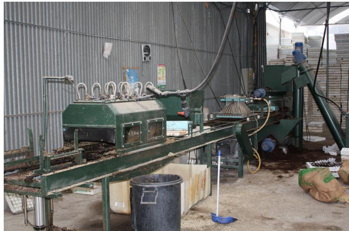
Figura 42. Detalle del tren de siembra.
