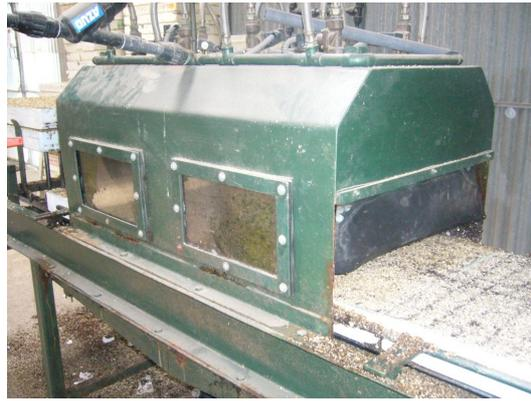
*Figura 18. Detalle de un túnel de riego*
