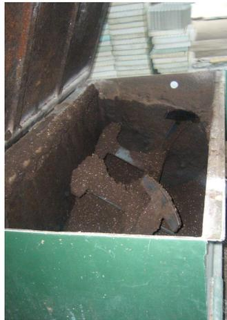
*Figura 11. Detalle de un mezclador de sustratos*
