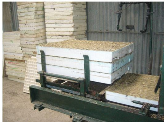
*Figura 19. Detalle de un apilador de bandejas*
