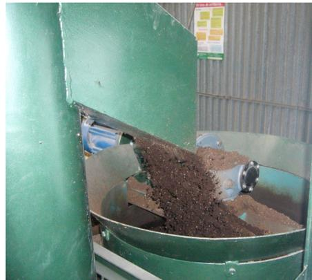
*Figura 13. Detalle de un alimentador de bandejas*
