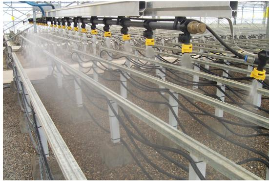
*Figura 25. Detalle de un tren de riego*
