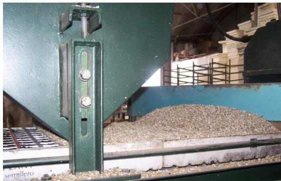
*Figura 17. Detalle del módulo de tapado de bandejas*
