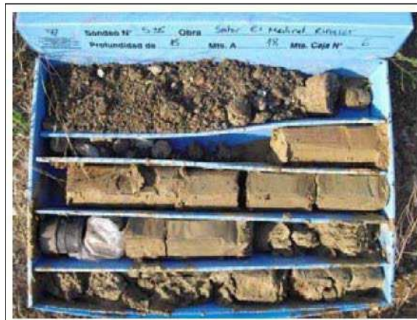
- Figura 1.6. Detalle del nivel de gravas con matriz arenosa antes de penetrar en el sustrato Mioceno (primera fila de la caja).
