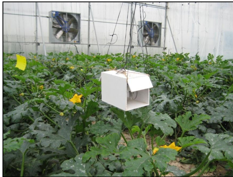
Figura 11. Detalle de un sensor de temperatura y humedad relativa en el interior de un invernadero (Hobo).
