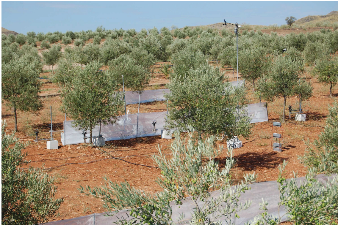
Fig. 4. Disposición de las barreras en el campo donde se incluye la distribución de anemómetros.
