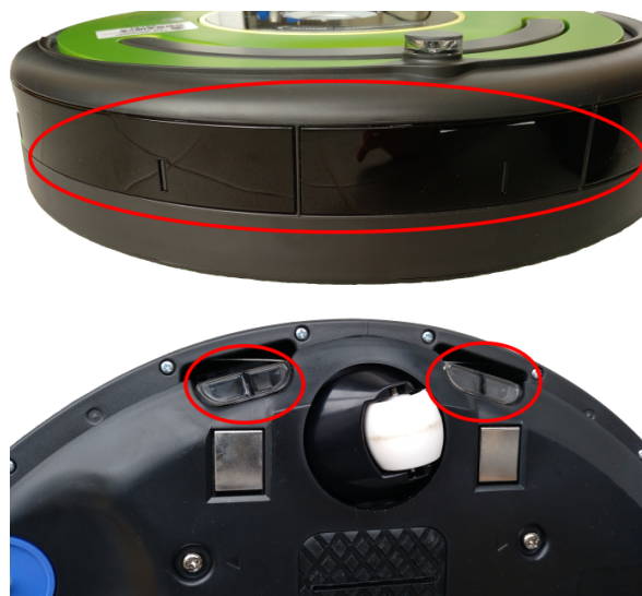
Figura 3.1.1.2: Sensores infrarrojos horizontales (superior) y verticales (inferior)
