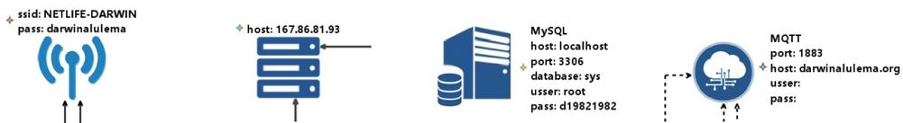
Figura 5.3: Nivel de Infraestructura del escenario de prueba de un sistema IoT.
