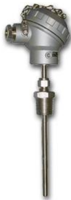
Figura 4.2. Medidor de temperatura resistivo comúnmente conocido como PT100, ya que su valor de resistencia es de aproximadamente 100 ohmios cuando se encuentra midiendo temperaturas alrededor de 0°C.
