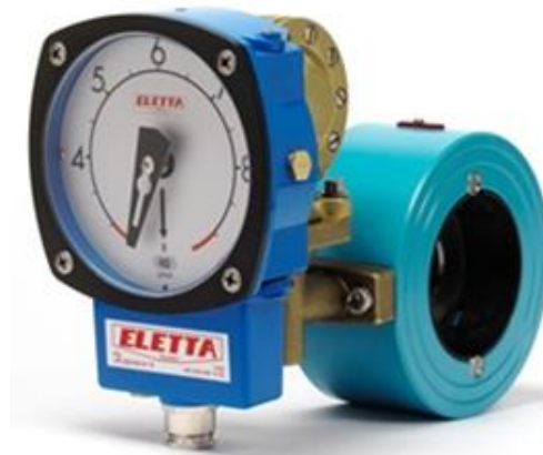
Figura 4.6. Medidor de flujo para líquidos con contactos de máximo y mínimo. Ajustable entre 1,5 y 30 l/min. Cortesía de Eletta ®.
