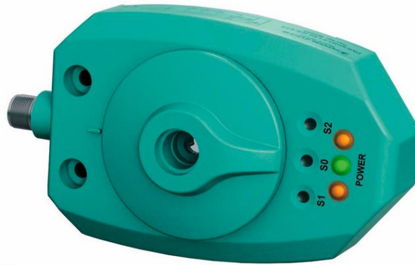
Figura 4.14. Sensor de posicionamiento inductivo modelo PMI360D-F130-R2-V15 de la marca Pepperl+Fuchs ®. Alimentación a 24 Vdc y salida de 4 a 20 mA regulables entre 0 y 360°.
