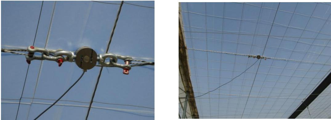
**Figuras 17 y 18:** Detalles del sistema de colocación de la célula de tracción.
