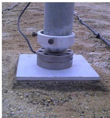
**Figura 19:** Detalle del sistema de colocación de la célula de compresión.
