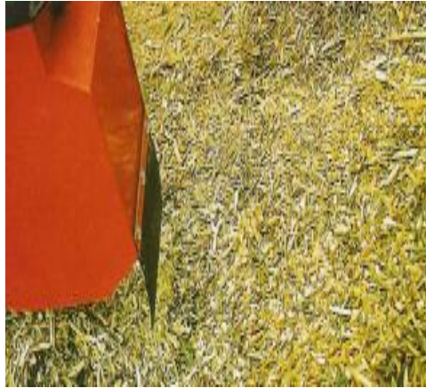
Fotografía 9.- Detalle de la boca de expulsión de restos de poda triturada en una trituradora alimentada manualmente. Fuente.- www.agroinformación.com
