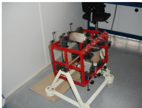
Fotografía 23.- Detalle de agitador mecánico.
