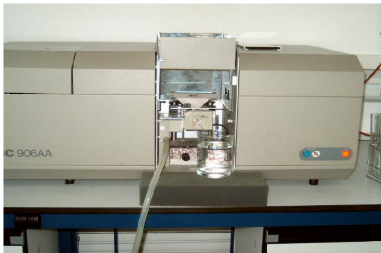
Fotografía 27.- Aparato de absorción atómica utilizado para la medida del Calcio y el Magnesio.
