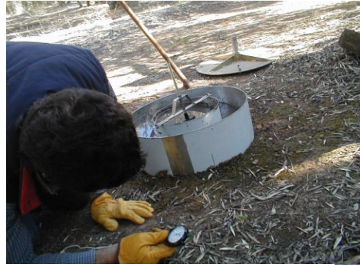
Fotografía 22.- Detalle de la toma de medidas de la velocidad de infiltración.
