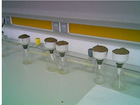
Fotografía 32.-Detalle de la extracción: Se observan los recipientes con la pasta saturada, los embudos Buchner sobre los Kitasatos conectados a la batería de llaves unida a la bomba de vacío.
