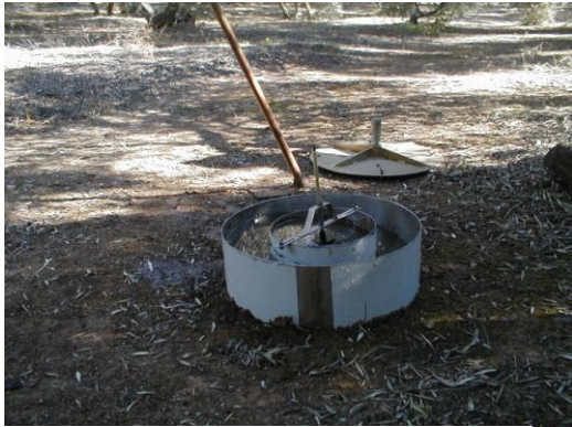
Fotografía 21.- Montaje del infiltrómetro en la parcela con suelo desnudo.
