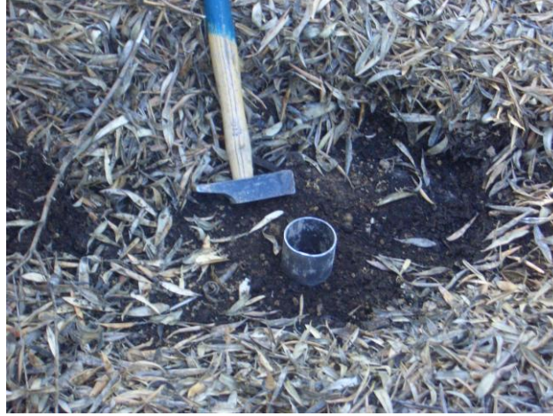
Fotografía 18.- Cilindro utilizado para la toma de muestras, se golpea con el taco de madera para no deformarlo.
