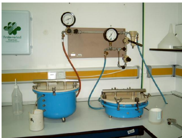
Fotografía 19.- Equipo de ollas de presión utilizado para la extracción del agua retenida en el suelo a distintas presiones.
