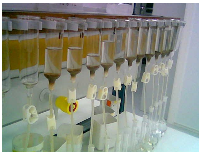
Fotografía 25.- Detalle de los embudos de percolación.
