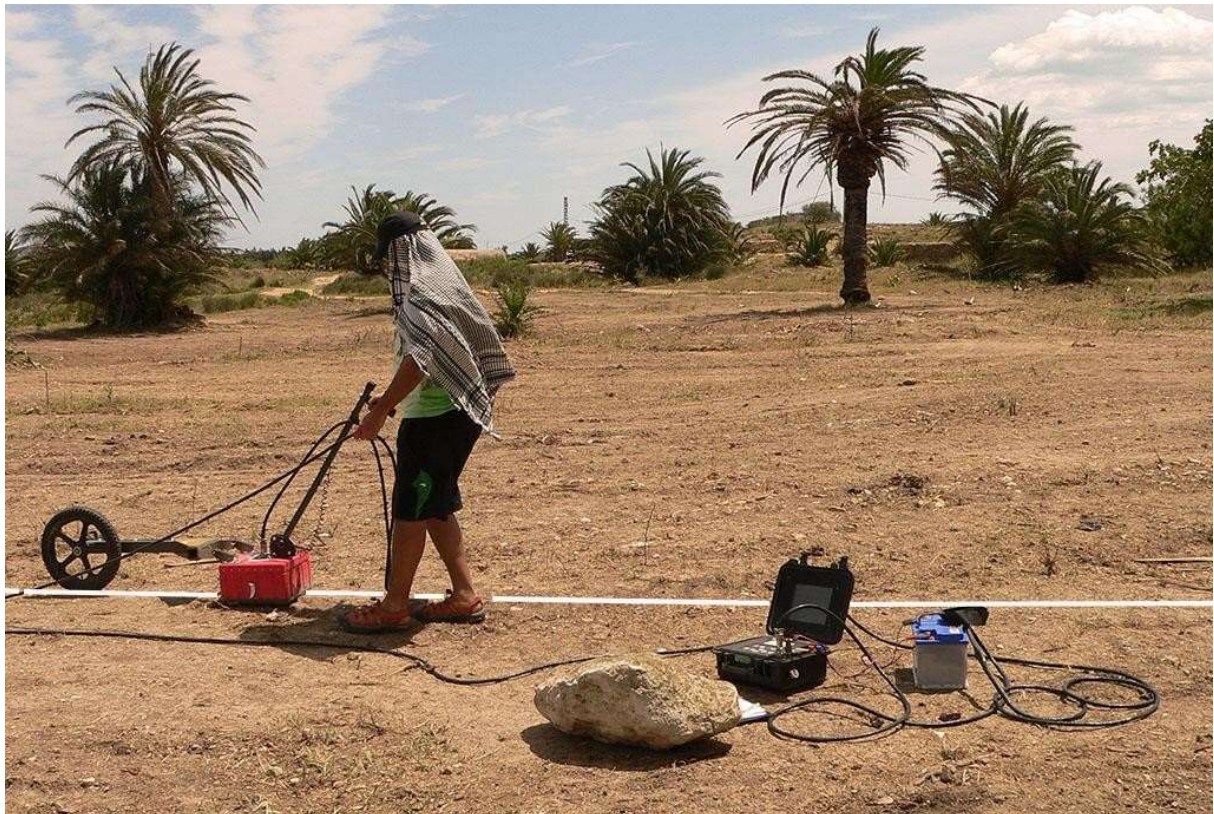
Fig. 3. Adquisición de un perfil rádar con la antena de 400 MHz. El hilo guía en el terreno que marca la trayectoria por donde se adquiere el perfil. El odómetro, rueda marcadora adosada a la antena, facilita la medición precisa de distancias. En primer plano la consola donde se almacenan y gestionan los datos, la fuente de alimentación es una batería de plomo-ácido convencional.
