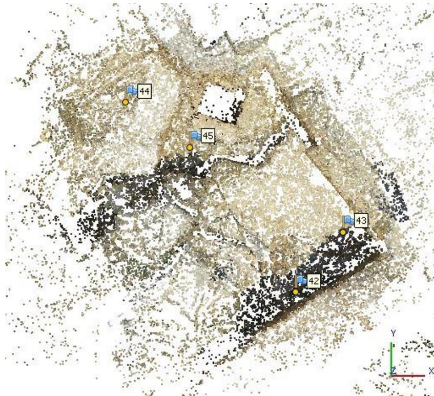
*Figura 3.44. Nube de puntos dispersa. Corte 11-sector C*
