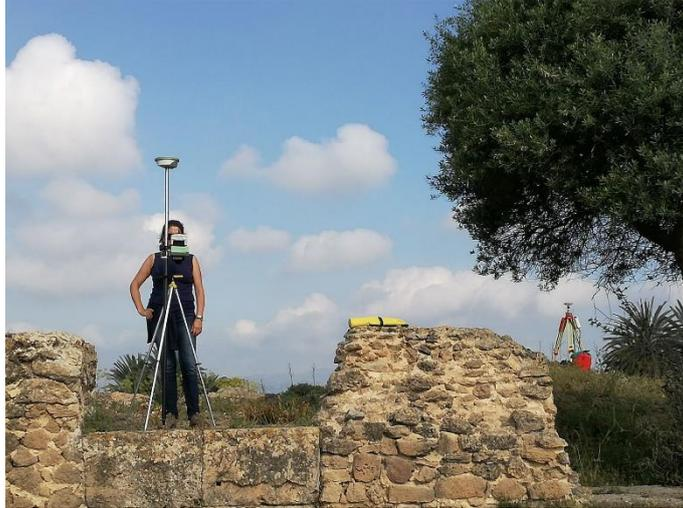
Figura 2.3. Emplazamiento antena referencia GNSS con equipo RTK
