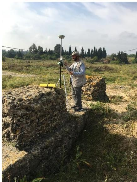
Figura 2.4. Equipo RTK en punto A, medición campaña 2018
