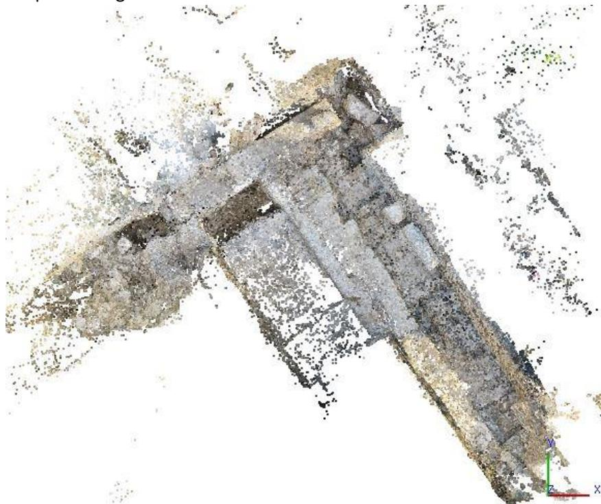
Figura 3.68. Nube de puntos dispersa. Corte 11-sector F
