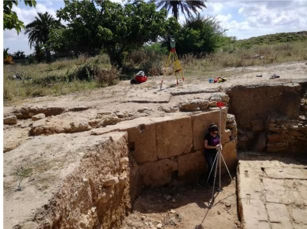
Figura 3.4. Medición con la Estación total TCR703. Corte 20
