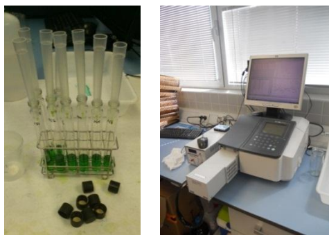
Figura 10. Extracción de carbohidratos no estructurales y determinación de su contenido mediante espectrofotometría UV-VIS.
