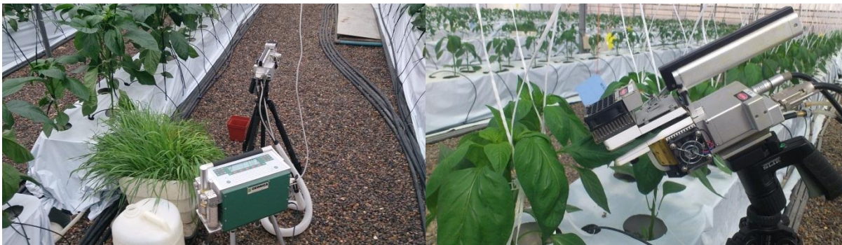
Figura 8. Equipo portátil de intercambio gaseoso (LI-6400; LI-COR Inc.) y detalle de toma de medida.
