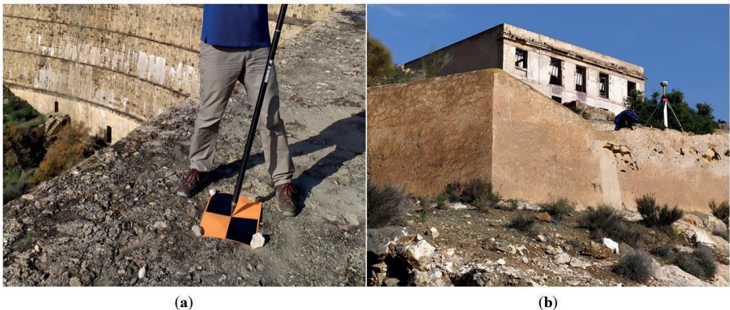
Figura 17. A) Ejemplo de un GCPs. B) Base de receptor GNSS utilizada.
