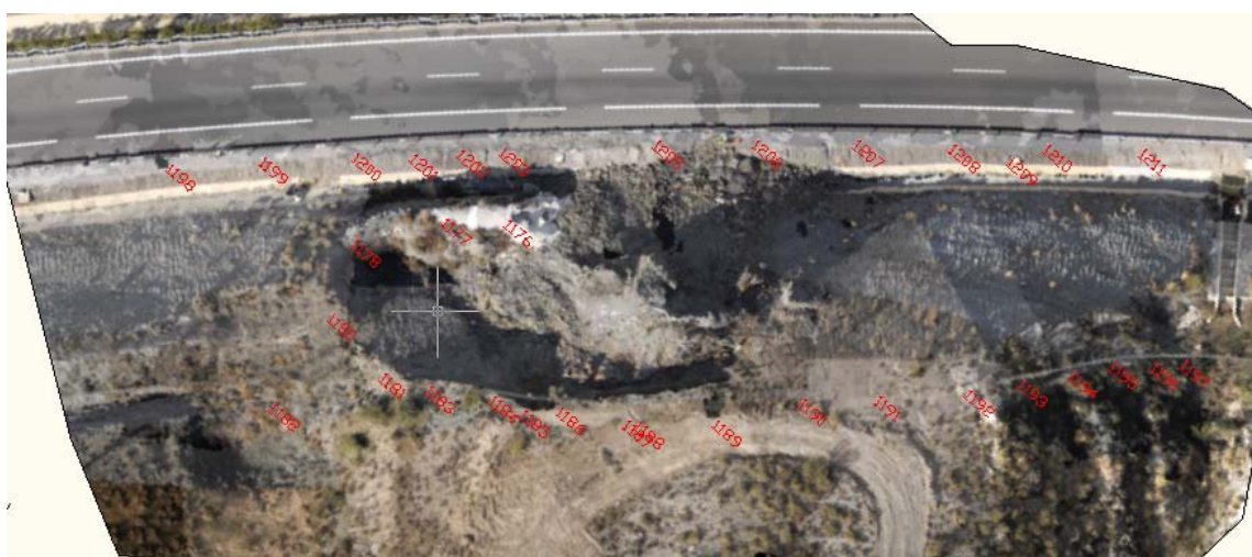
Fig. 2.1.7. Puntos de control obtenidos "in situ" con GPS
