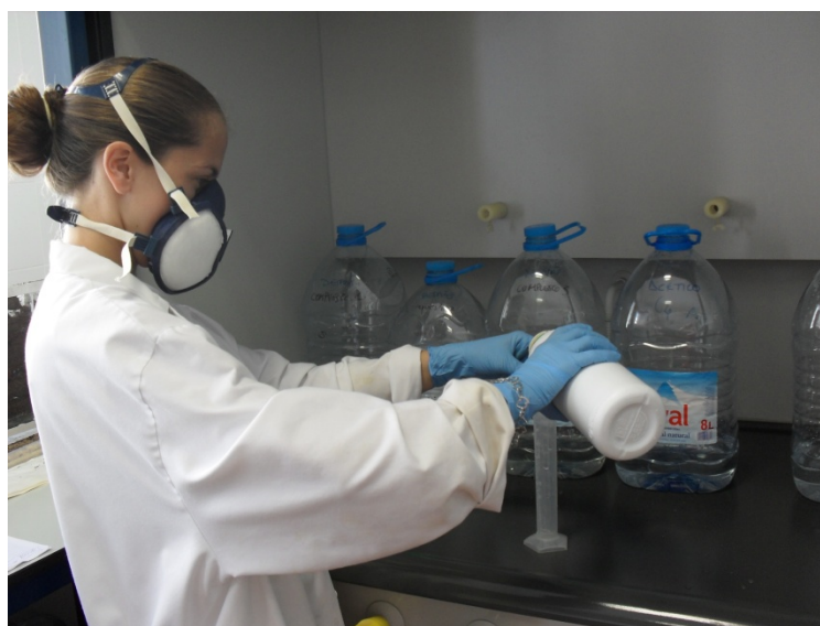
Figura 21: Preparación de las soluciones de los productos de aplicación en la Fase 2: Nematicida (post-trasplante) en la campana extractora de gases.
