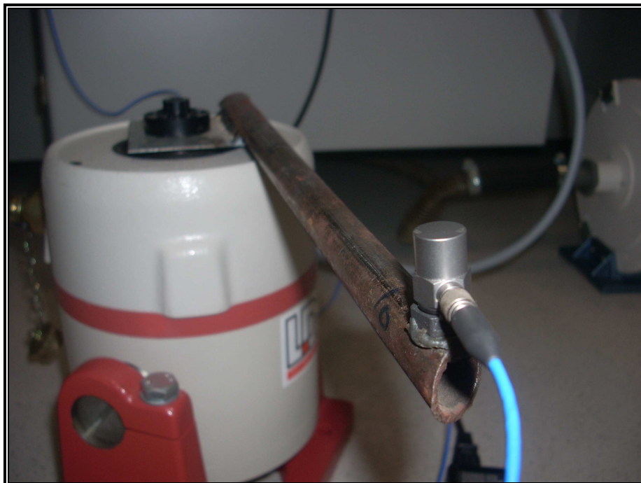
Figura 83. Colocación del acelerómetro en la posición más desfavorable
