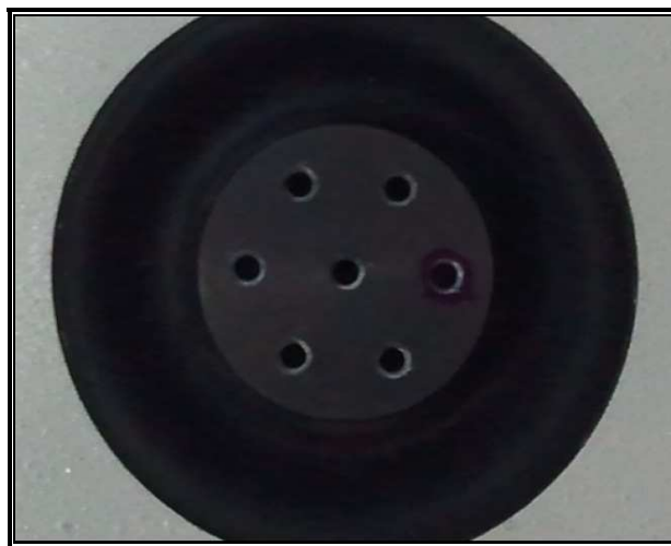
Figura 77. Zona de sujeción de la mesa de vibraciones
