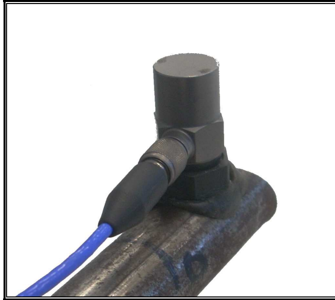
Figura 81. Unión acelerómetro con resina
