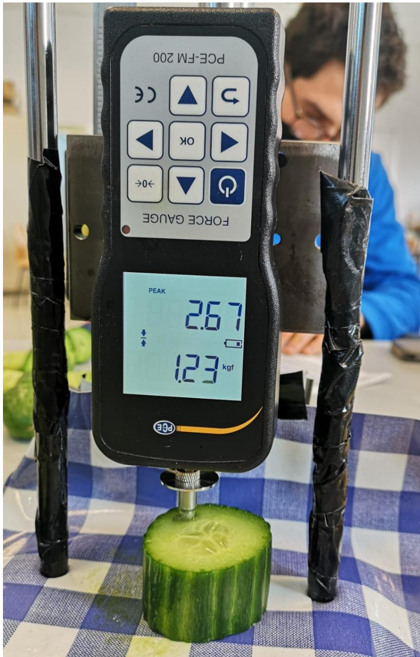
Ilustración 27. Medición de la firmeza en frutos de pepino. Fuente: elaboración propia.
