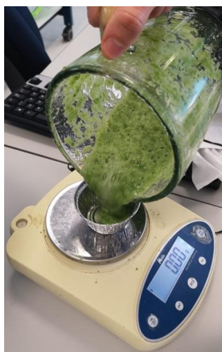
Ilustración 32. Vertido del triturado del fruto de pepino tipo LET a una bandeja de aluminio. Fuente: elaboración propia.
