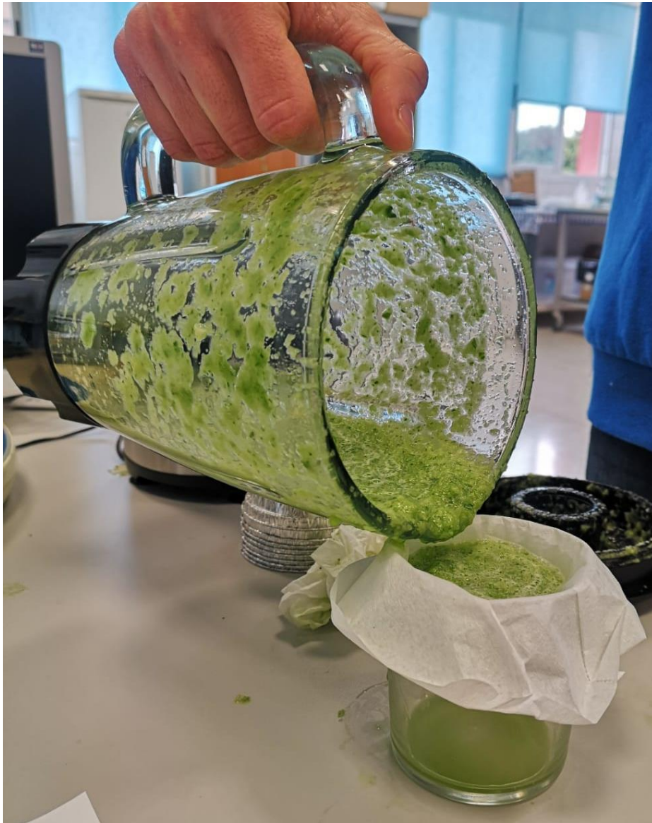
Ilustración 30. Filtración del triturado de pepino tipo LET con papel de filtro. Fuente: elaboración propia.
