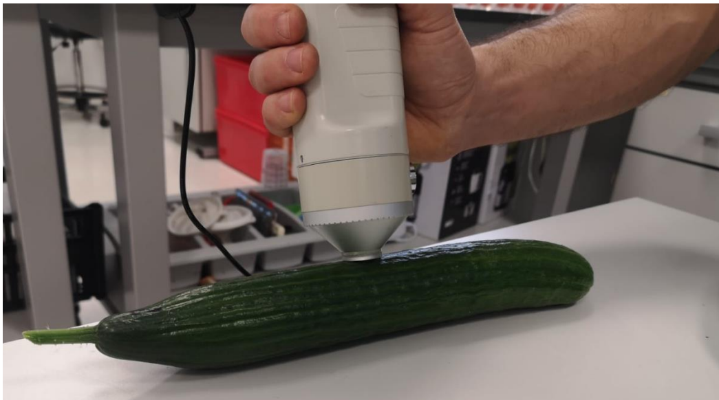
Ilustración 24. Detalle de medición del color de la epidermis del fruto de pepino en el punto central del fruto. Fuente: elaboración propia.
