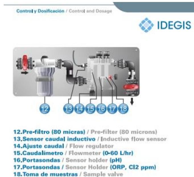
Ilustración 38. Esquema dosificación automática
