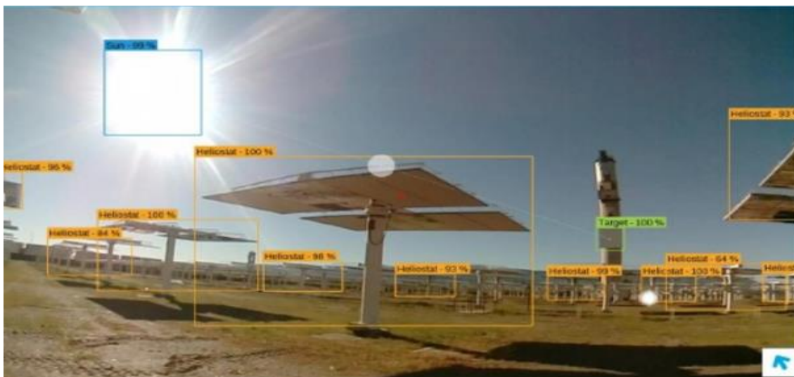
Figura 2.31. Imagen analizada por una red neuronal convolucional en la PSA [51].
