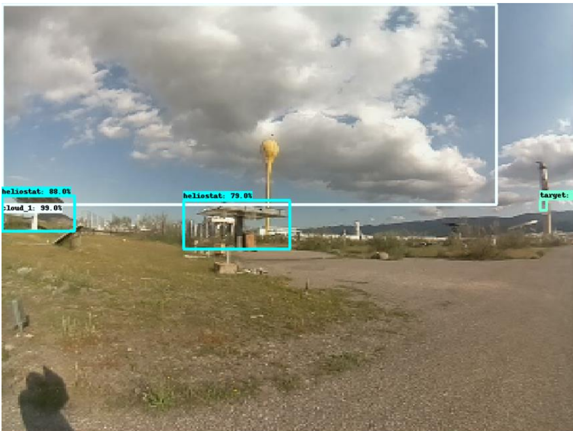
Figura 4.11. Detecciones del modelo 11 MobileNet sobre imagen nº 2
