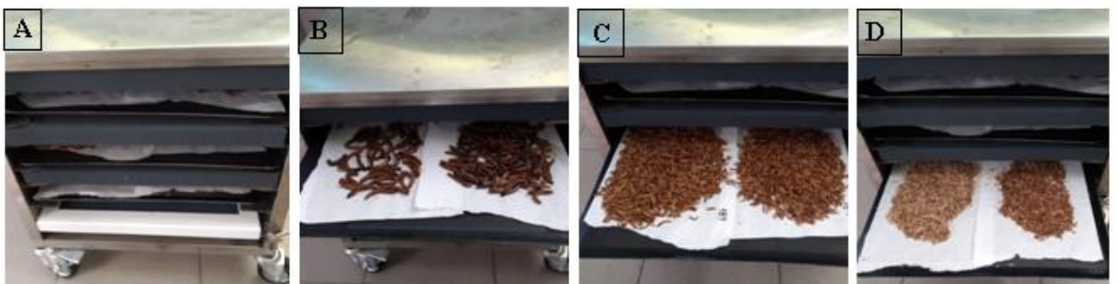
Figura 4-5 – Método de deshidratación por infrarrojo. (A) Equipo utilizado (B) Muestras de Zophoba morio (C) Muestras de Tenebrio molitor (D) Muestras de Hermetia illucens .
