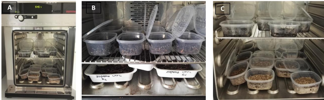
Figura 4-3 – Método de deshidratación por estufa. Equipo utilizado (A) Muestras de Zophoba morio (B) Muestras de Tenebrio molitor y Hermetia illucens (C).
