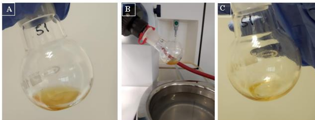
Figura 4-7– Metodología de secado mediante destilación. (A) Matraz con el extracto a secar (B) Rotavapor con el matraz (C) Matraz con el extracto seco.
