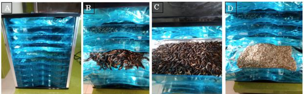
Figura 4-4 – Método de deshidratación por convección. (A) Equipo utilizado (B) Muestras de Zophoba morio (C) Muestras de Tenebrio molitor (D) Muestras de Hermetia illucens
