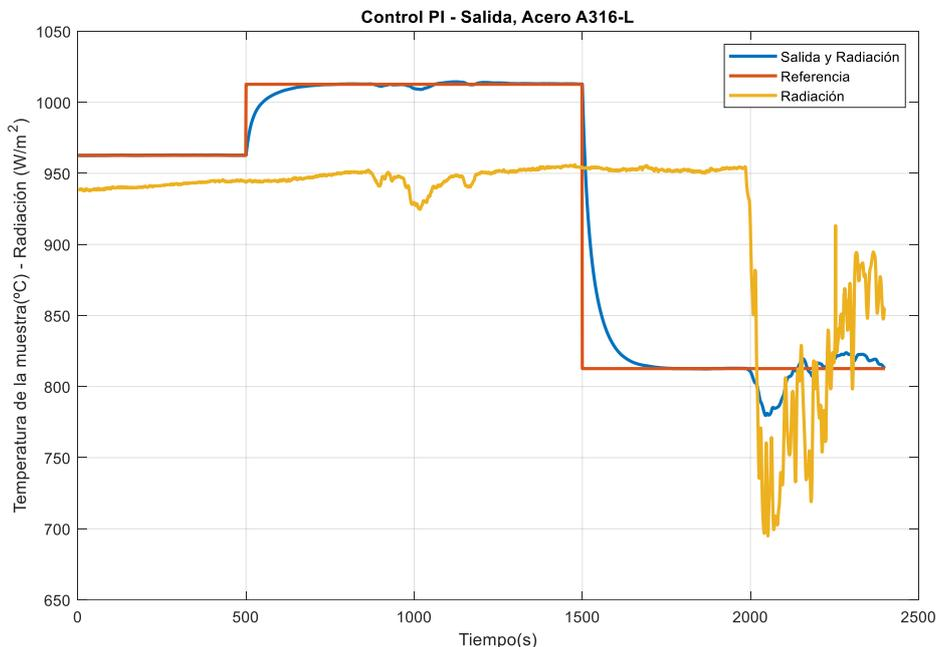
Figura 3.239. Ensayo de controlador PI + antiwindup + control anticipativo para estudiar el efecto del control anticipativo, gráfica de la salida. Muestra de acero.
