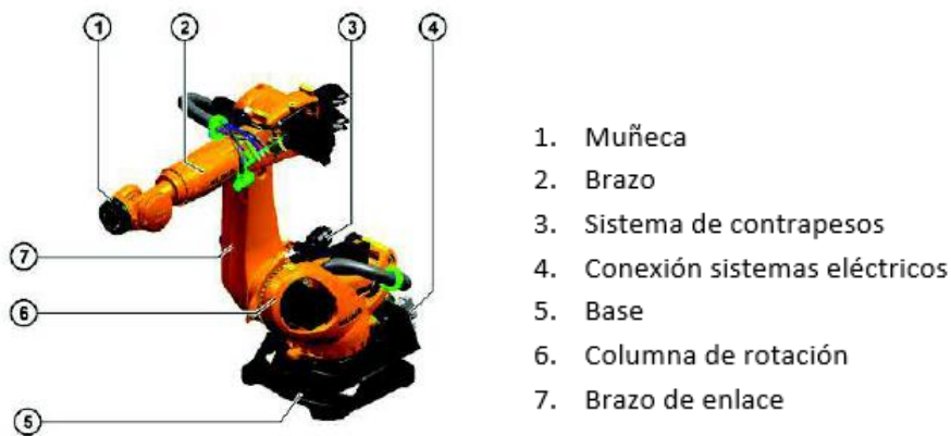
Figura 3. 9. Partes del manipulador del robot
