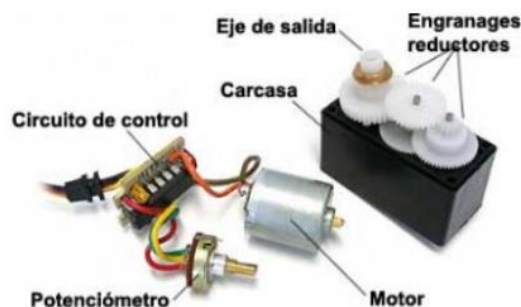
Figura 3. 19. Servomotor desmontado
