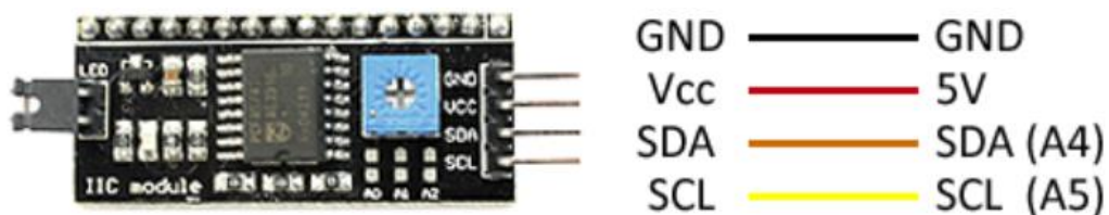
Figura 3. 42. Conexiones del módulo I2C para pantalla LCD
