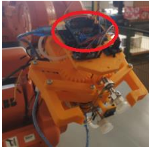
Figura 4. 92. Situación Arduino Uno sobre la herramienta
