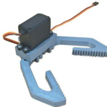
Figura 3. 45. Sistema pinza de transmisión directa
