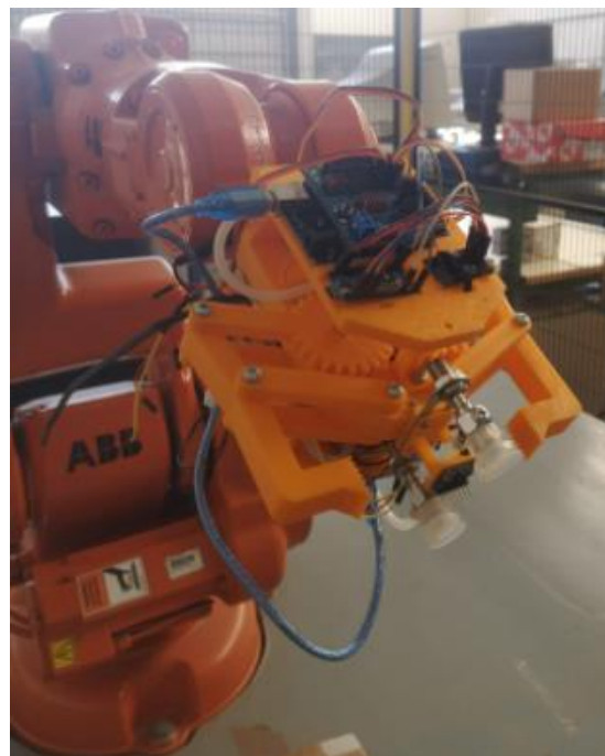
Figura 4. 81. Ensamblaje herramienta completa (Vista izquierda)
