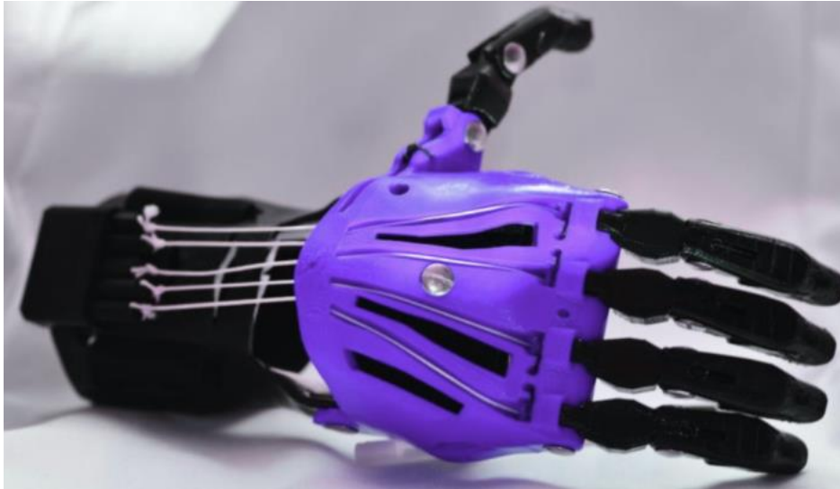
Figura 3. 17. Prótesis fabricada mediante impresión 3D
