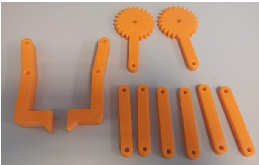
Figura 4. 69.ESLABONES SIMPLES (6), ESLABONES PINZA (2) Y ESLABONES CON ENGRANAJE (1 Y 2)
