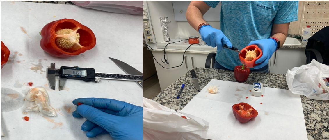
Figura 12. Medida del espesor de la pared con un Pie de Rey digital. Fuente: Elaboración propia.
