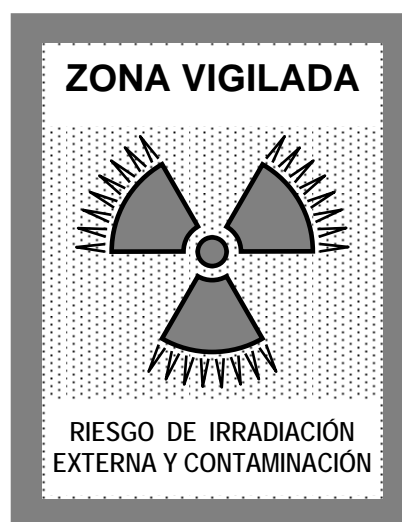
Ilustración 1: Trébol Gris de señalización de zona vigilada con riesgo de contaminación (punteado) e irradiación (picas).
