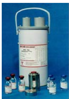
Figura 1: Generador y viales de Radiofármacos.
