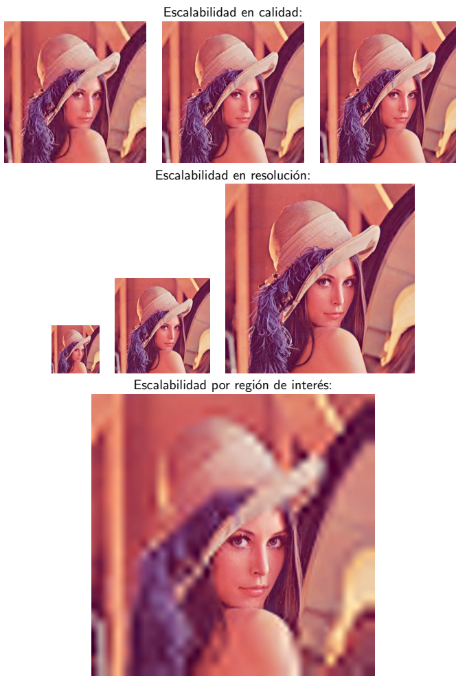
Figura 17. Las tres formas de escalabilidad en JPEG 2000.
