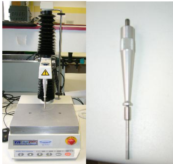
Figura 21A (izquierda). Texturómetro del laboratorio 222 de la Escuela Superior de Ingeniería de la Universidad de Almería. Figura 21B (derecha). Cabezal utilizado para realizar el ensayo de penetración en el fruto.
