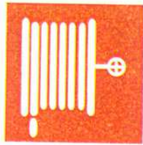
Manguera para incendios
