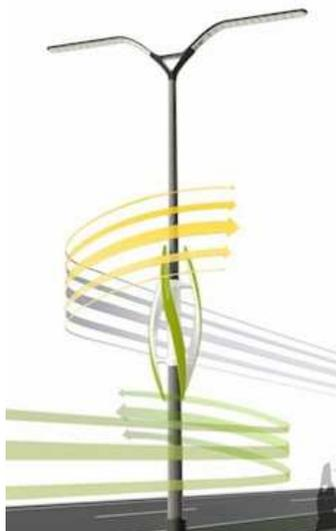
Figura 3.13. Esquema aerogeneradores en postes
