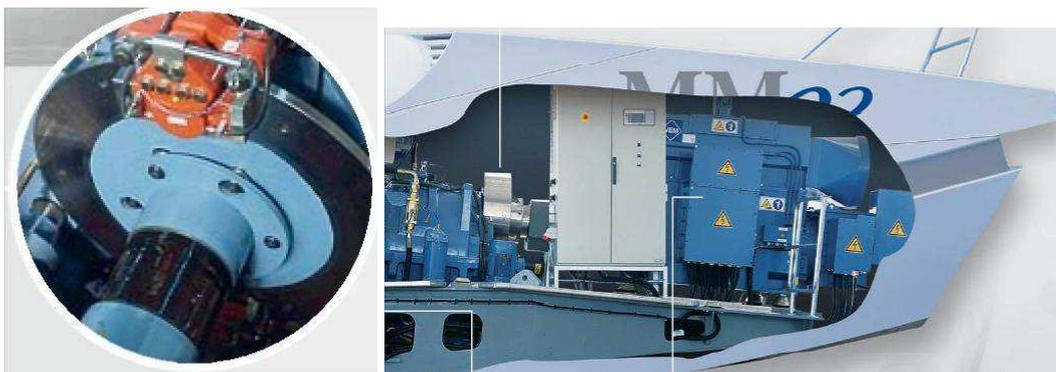
Figura 2.19. Imágenes del freno mecánico
