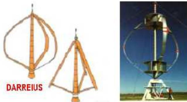
Figura 2.29. Imágenes aerogeneradores tipo Darrieus
