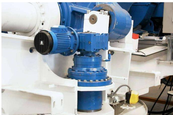
Figura 2.23. Mecanismo de orientación
