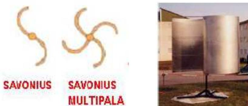
Figura 2.30. Aerogenerador tipo Savonius
