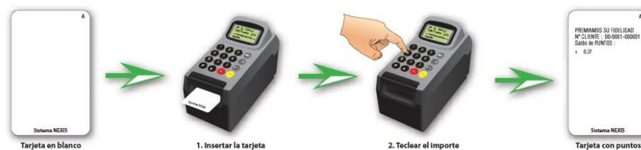
**Figura 6. Funcionamiento del Sistema.**
