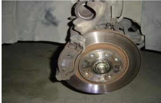
Figura 3. Cambio de pastillas de freno.
