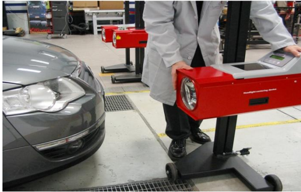
Figura 2. Alineación de faros delanteros con máquina centradora de faros.
