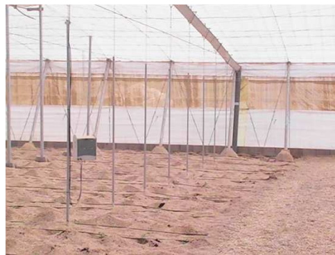
Figura 3.11. Fotografía en la que se observa un psicómetro instalado en la zona testigo.
