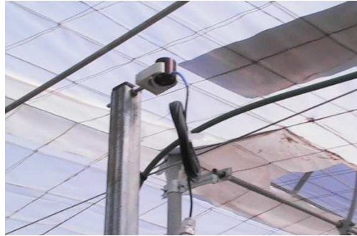
Figura 3.12. Fotografía en la que se observa un piranómetro de radiación PAR.
