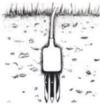
Figura 3.4 Recomendación del fabricante para la instalación del equipo 5TE en el suelo.
