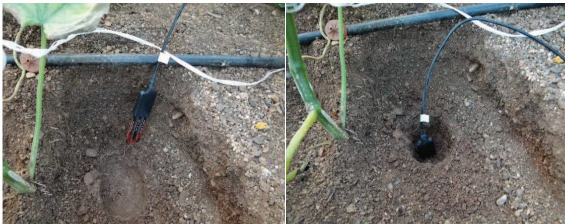
Fotografía 3.2 Detalle de la instalación de los equipos 5TE.
