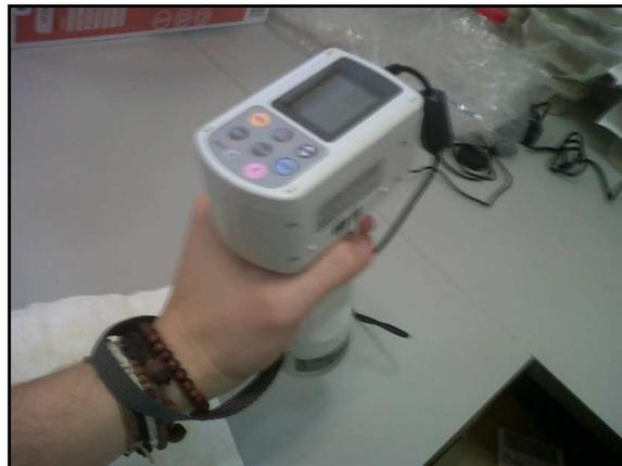
Figura 72. Detalle del colorímetro triestímulo utilizado durante el ensayo.
