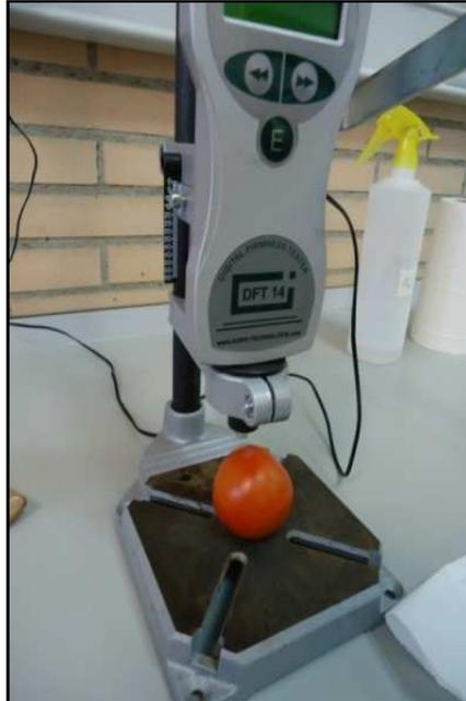
**Figura 75.** Penetrómetro empleado durante el ensayo.
