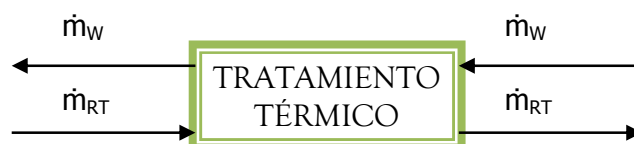
Figura 2.4. Diagrama de la unidad de proceso del tratamiento térmico \dot{m}_W , caudal másico de agua, \left(\frac{kg}{h}\right) ; \dot{m}_{RT} , caudal másico de RVI total, \left(\frac{kg}{h}\right) .
