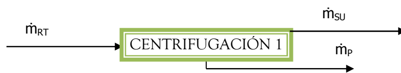
Figura 2.5. Diagrama de la primera unidad de centrifugación. \dot{m}_{\text{SU}} , caudal másico del suero, \left(\frac{\text{kg}}{\text{h}}\right) ; \dot{m}_{\text{P}} , caudal másico de la pulpa, \left(\frac{\text{kg}}{\text{h}}\right)
