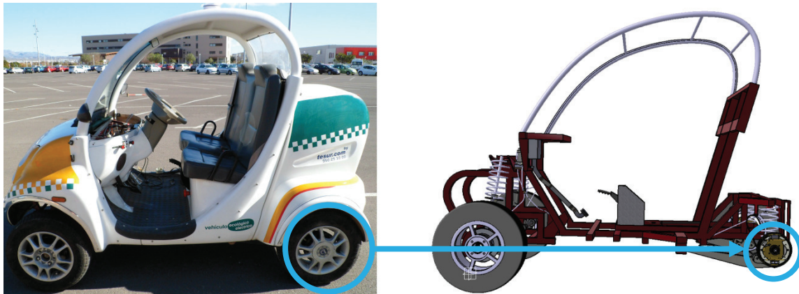
Imagen 88. Modelado en CATIA de la localización de frenos tambor del vehículo eléctrico
