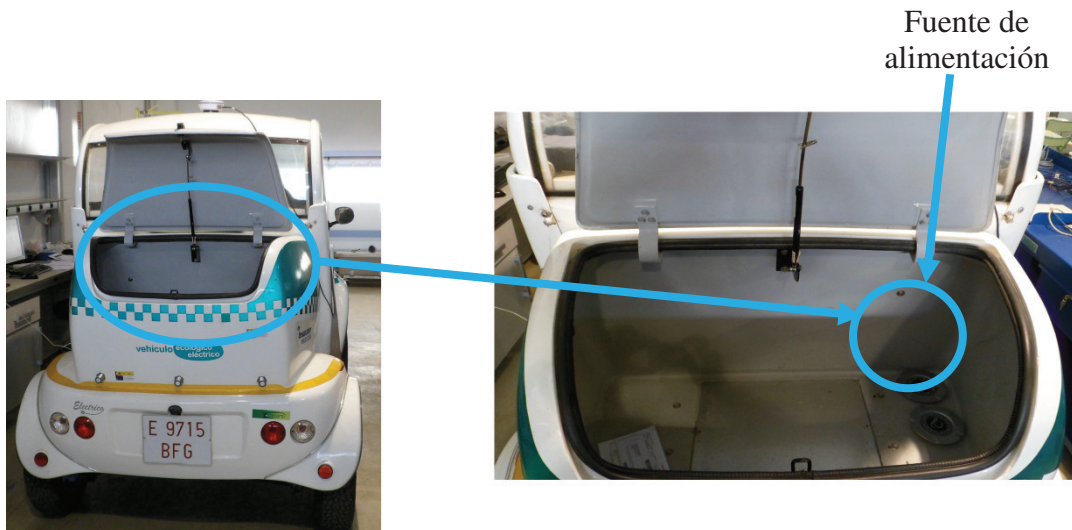
Imagen 82. Localización de taladros a realizar en el maletero
