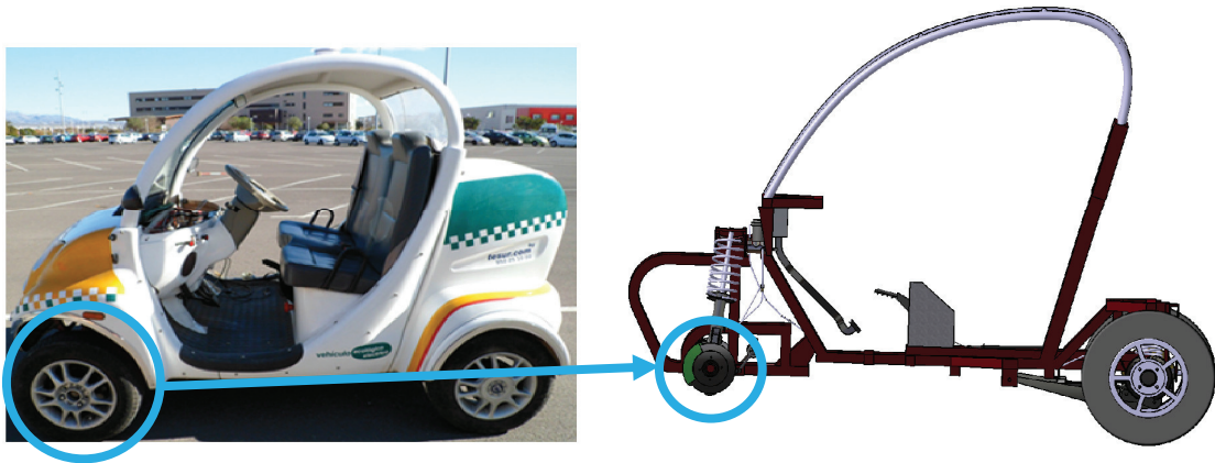
Imagen 91. Modelado en CATIA de la localización de frenos de disco del vehículo eléctrico
