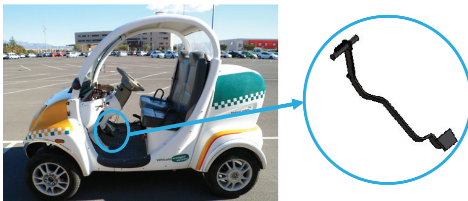
Imagen 85. Modelado en CATIA del pedal del freno del vehículo eléctrico
