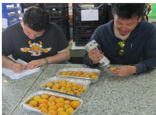
Figura 3.8. Determinación del color de la epidermis del fruto con colorímetro digital (Minolta CR-400).
